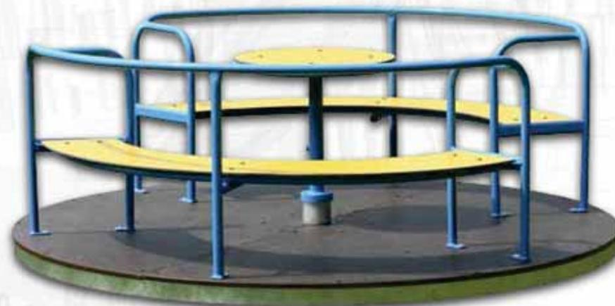
Il telaio è sormontato da un piano in multistrato marino spessore 15 mm con strati in legno esotico e incollaggio fenolico ad alta resistenza. Al lato sottostante viene incollata una pellicola liscia, mentre al lato soggetto al calpestio viene applicata una doppia pellicola antisdrucciolevole ad alta impermeabilità.
